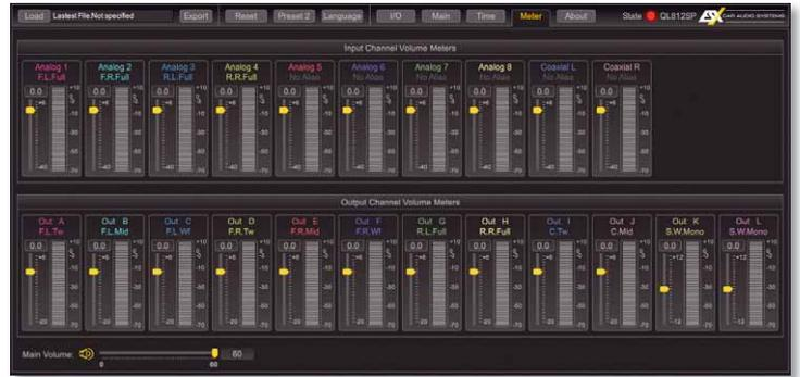
Im Bereich Meter wird für alle 8 analogen eingänge und 12 Ausgänge der anliegende Pegel angezeigt und direkt auch einjustiert
