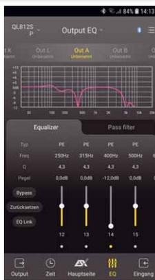
So werden im Ausgangsbereich die einzelnen Lautsprecher getrennt und laufzeitkorrigiert und der Ausgangs-EQ auf die Bedürfnisse des Lautsprechers einjustiert. Das bleibt dann fortan unangetastet, denn das Sounddesign geschieht dann per Eingangs-EQ und per Staging-EQ für z.B. Gesamt Front links. Zur vereinfachten Einstellung lassen sich zudem Kanäle verlinken, so dass Pegel und EQs
