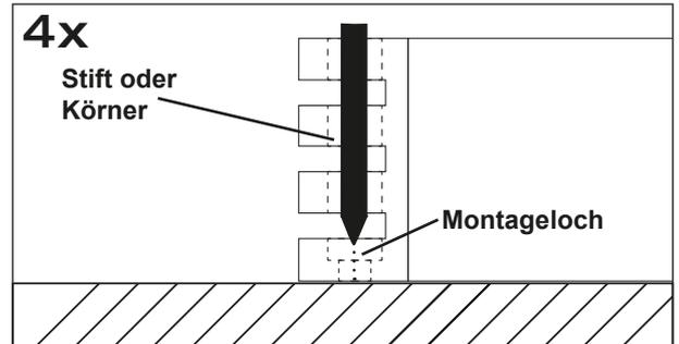
Belassen Sie dann den Prozessor an der gewünschten Einbaustelle im Fahrzeug. Markieren Sie die vier Bohrlöcher durch das jeweilige Montageloch an den Gussentteilen mit einem geeigneten Stift oder Körner.
