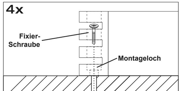
Halten Sie dann den Prozessor wieder an die zuvor gewählte Position und verschrauben Sie den Prozessor mit geeigneten Schrauben an den zuvor gebohrten Bohrlöchern mit dem Fahrzeug.
