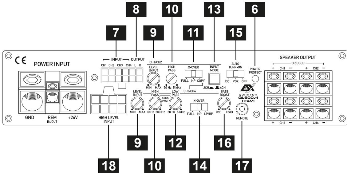
**6** Leuchtet die **POWER/PROTECT** LED blau, ist der Verstärker betriebsbereit. Leuchtet die **POWER/PROTECT** LED rot, liegt eine Fehlfunktion vor. Beachten Sie dann die Hinweise im Abschnitt **FEHLERBEHEBUNG**.
