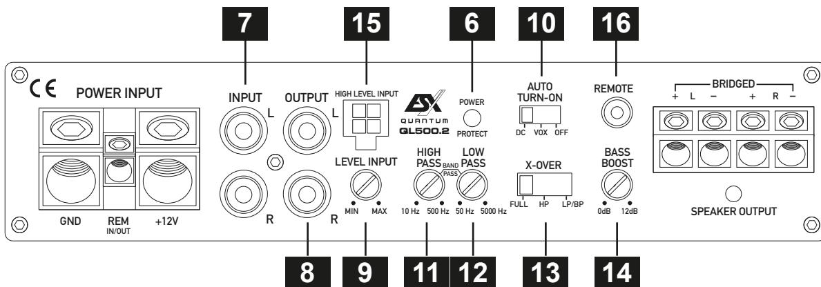
**6** Leuchtet die **POWER/PROTECT** LED blau, ist der Verstärker betriebsbereit. Leuchtet die **POWER/PROTECT** LED rot, liegt eine Fehlfunktion vor. Beachten Sie dann die Hinweise im Abschnitt **FEHLERBEHEBUNG**.
