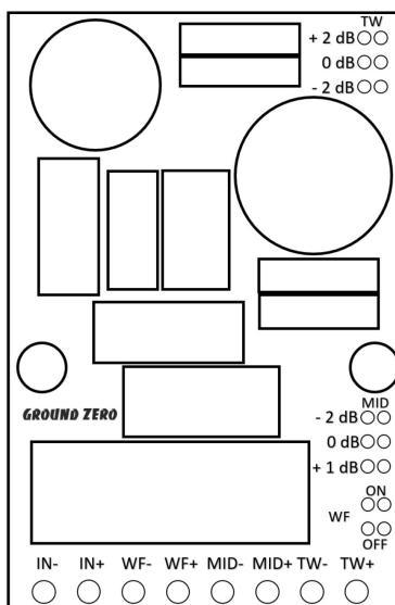
Anpassung des Hochtonpegels: Der Pegel kann über die Position der Steckbrücke gewählt werden
