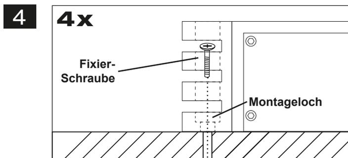
Legen Sie dann den Prozessor beiseite und bohren dann die Löcher für die Fixierschrauben an den zuvor markierten Punkten. Vergewissern Sie sich zuvor, dass keine Kabel, Leitungen und andere Komponenten des Fahrzeugs beim Bohren beschädigt werden. Alternativ können Sie auch (je nach Untergrund) selbstschneidende Gewindeschrauben verwenden.
