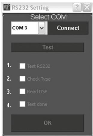
Stellen Sie im **RS232 Setting** die Verbindung mit dem DSP her. Die COM Schnittstelle sollte in der Regel automatisch erkannt und ausgewählt werden, sie variiert von System zu System. Klicken Sie auf **Connect**. Das Programm verbindet sich nun automatisch.
