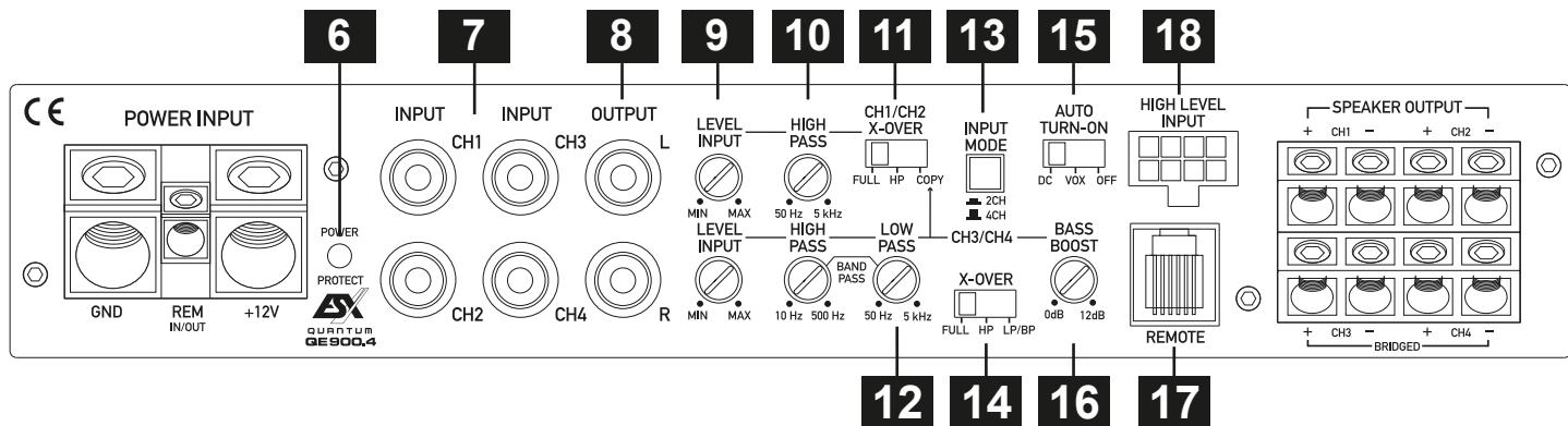
**6** Leuchtet die **POWER/PROTECT** LED blau, ist der Verstärker betriebsbereit. Leuchtet die **POWER/PROTECT** LED rot, liegt eine Fehlfunktion vor. Beachten Sie dann die Hinweise im Abschnitt **FEHLERBEHEBUNG**.
