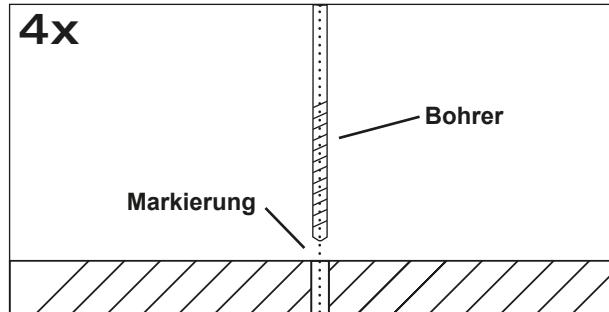
Legen Sie dann den Prozessor beiseite und bohren dann die Löcher für die Fixierschrauben an den zuvor markierten Punkten. Vergewissern Sie sich zuvor, dass keine Kabel, Leitungen und andere Komponenten des Fahrzeugs beim Bohren beschädigt werden. Alternativ können Sie auch (je nach Untergrund) selbstschneidende Gewindestellschrauben verwenden.
