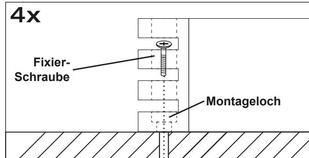
Halten Sie dann den Prozessor wieder an die zuvor gewählte Position und verschrauben Sie den Prozessor mit geeigneten Schrauben an den zuvor gebohrten Bohrlöchern mit dem Fahrzeug.
