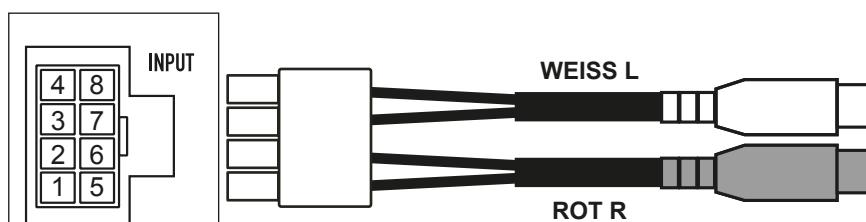
VERBINDEN SIE DIE RCA/CINCH BUCHSEN MIT DEN VORVERSTÄRKER-AUSGÄNGEN DES STEUERGERÄTS/AUDIORADOS
