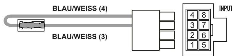
VERBINDEN SIE DIE BLAU/WEISSEN KABEL UM DIE AUTOMATISCHE EINSCHALTFUNKTION (AUTO TURN-ON) ZU AKTIVIEREN.
