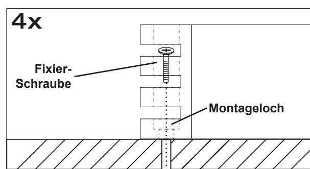
Legen Sie dann den Prozessor beiseite und bohren dann die Löcher für die Fixierschrauben an den zuvor markierten Punkten. Vergewissern Sie sich zuvor, dass keine Kabel, Leitungen und andere Komponenten des Fahrzeugs beim Bohren beschädigt werden. Alternativ können Sie auch (je nach Untergrund) selbstschneidende Gewindestellschrauben verwenden.
