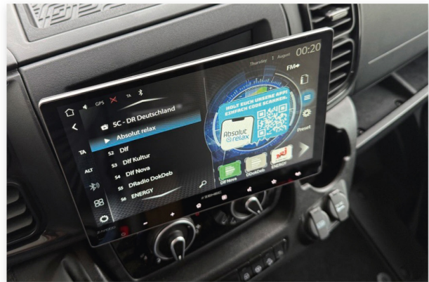
Einbau Z-N1000 in Fiat Ducato III, ab Serie 8, Montage mit Kugelgelenk*
