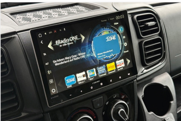
Einbau Z-N1000 in Fiat Ducato III, ab Serie 8, Montage ohne Kugelgelenk*
